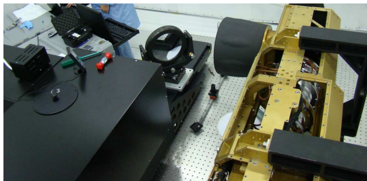
Figura 5 – Montagem experimental usada no teste de função de transferência de modulação global da câmera MUX (câmera completamente integrada). FONTE: Opto Eletrônica S.A.
