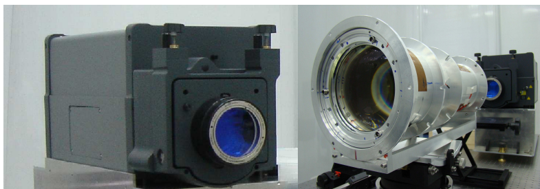
Figura 2 - Interferômetro Zygo GPI – XP/D e canhão óptico da MUX posicionado para a medida com interferômetro. FONTE: Opto Eletrônica S. A.
