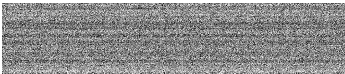
Figura 1: Imagem escura obtida com o sensor HSS, para a banda 7, com uma frequência de varredura de 6,25 Hz, para o IFOV de 2,5 mrad. Na vertical são mostradas as 150 linhas e na horizontal 720 colunas correspondentes ao FOV de 86° do sensor. Os tons de cinza representam os valores digitais da imagem escura.
