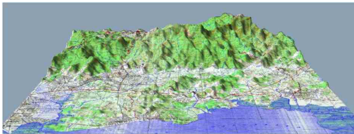
Figura 5: DEM do SRTM associado à imagem de uma carta topográfica.
